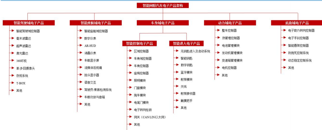
图 6：智能网联汽车电子产品架构
