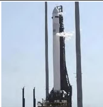
图表 54. Relativity Space 人族 1 号全 3D 打印火箭
