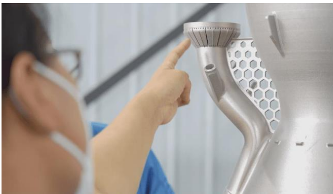
图表 81. 深蓝航天使用华曙高科设备进行发动机大尺寸喷管3D打印
