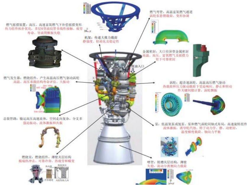
图表 49. 大推力液体火箭发动机典型结构
