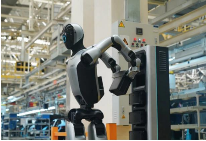
图表 27：优必选工业人形机器人自主换电
