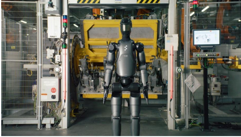
图表 22：在宝马工厂部署的 Figure 02 人形机器人
