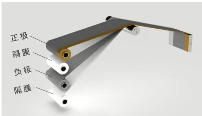
图表 36: 卷绕工艺将相极片和隔膜等按尺寸卷成极芯
