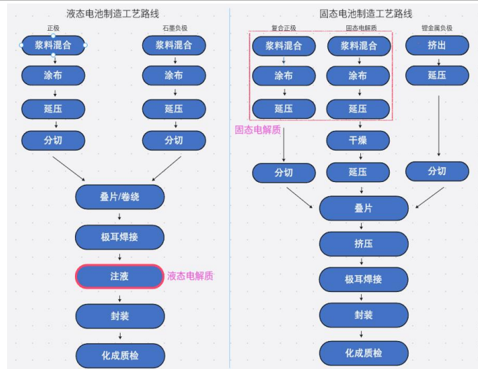
图表 12：固态电池与液态电池在生产流程上存在差异
