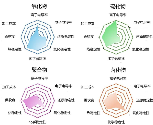
图表 26: 硫化物在离子电导率和柔软性方面具有优势
