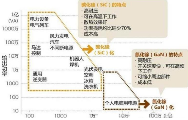
图2: GaN 功率器件更适配输出功率较低、工作频率高频、成本要求严苛的工况环境
