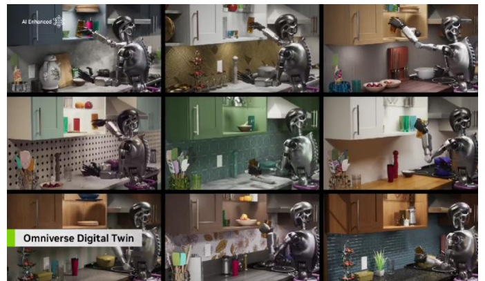
图表20: 机器人在 Isaac Sim 中的不同仿真环境下训练
