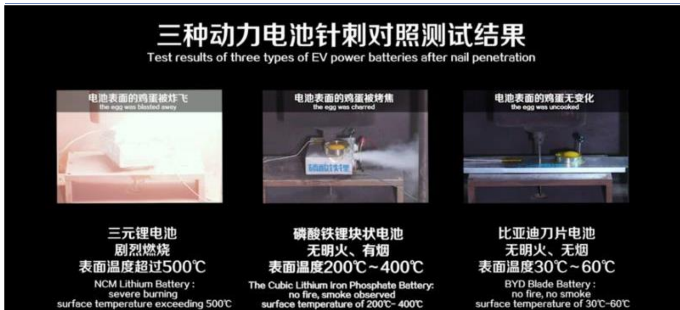
图8：“刀片电池”在“针刺穿透测试”中的表现明显好于三元锂电池与磷酸铁锂块状电池
