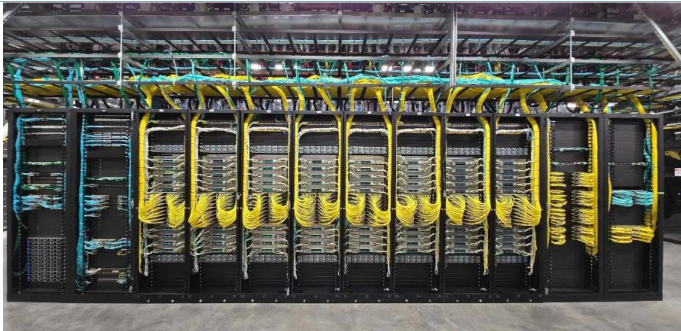
图表7: NVIDIA Polype 原型，基于 GB200 的多机架 NVL576 纵向扩展系统
