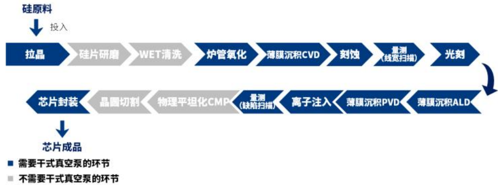
图表 2：光刻、薄膜沉积等 11 个主要半导体制程工艺环节都需要使用真空泵
