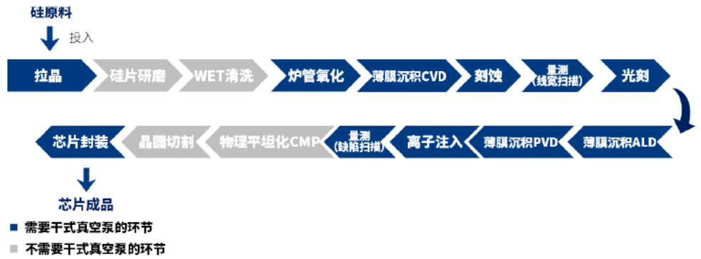
图7：真空泵是半导体制造真空系统的核心关键部件
