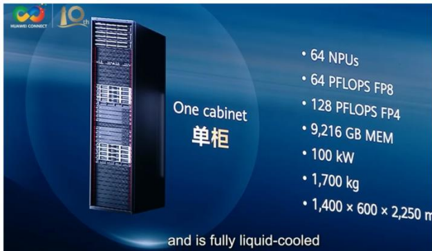
图表 3：华为 Atlas 950 SuperPod 单柜参数
