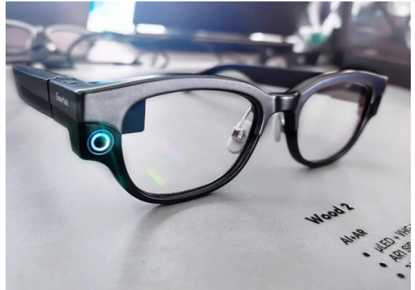
图21: 歌尔股份 Wood2 采用超小型 SiP 模组技术
