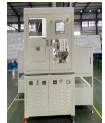
HBQ-G205 光伏连接器自动组装机 (长宽高: 2.8m*1.5m*2m)
