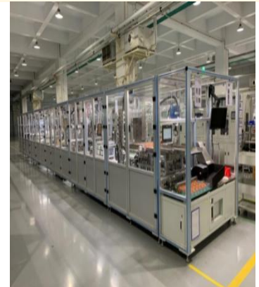
HBQ-K638 高压连接器柔性线 (长宽高: 16.5m*3.3m*2m)
