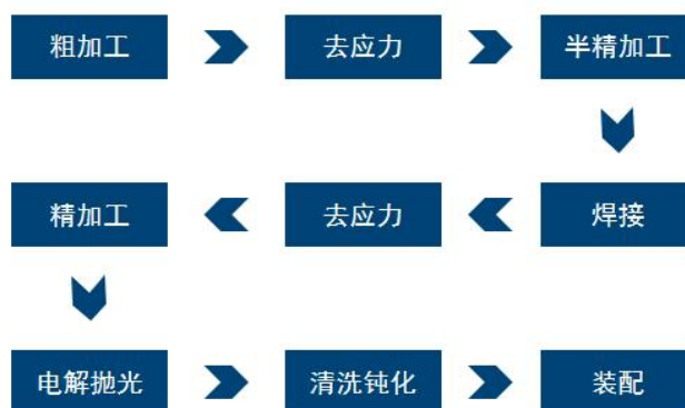
图28: Manifold 加工过程中的工艺流程
