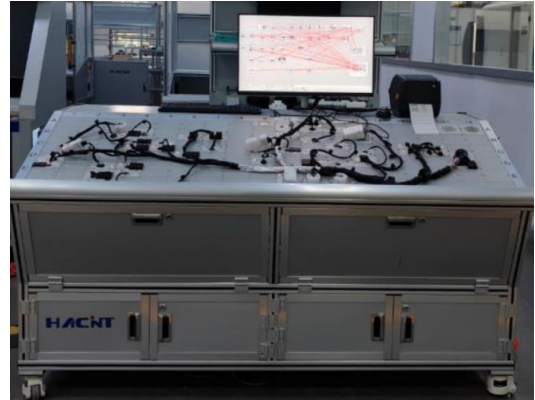
图15: CS 型线束检测系统
