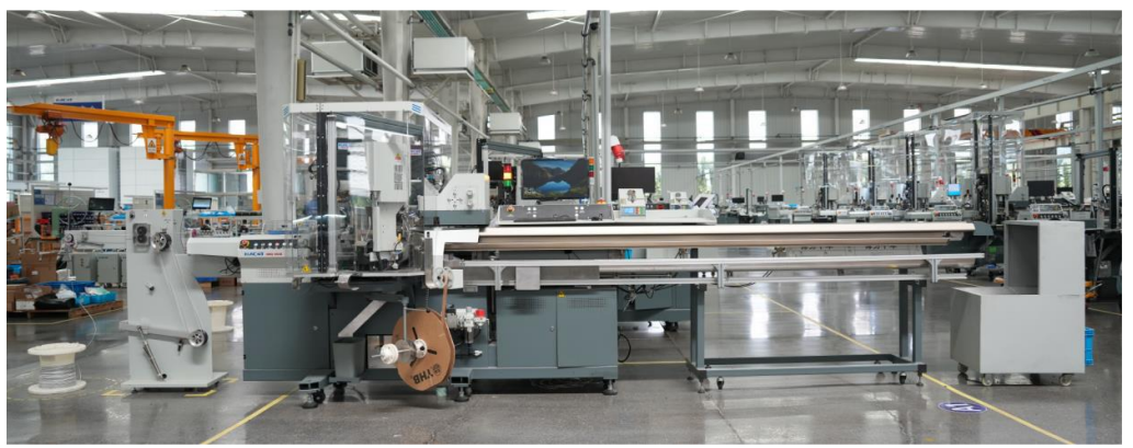
图4：HBQ-804E 型全自动下线压接机
