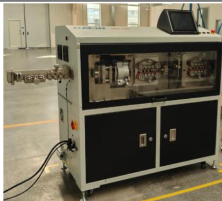
图11：HBQ-421 全自动屏蔽线下线机
