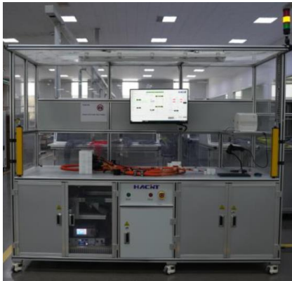
图14: HCS6000 新能源线束高压检测台
