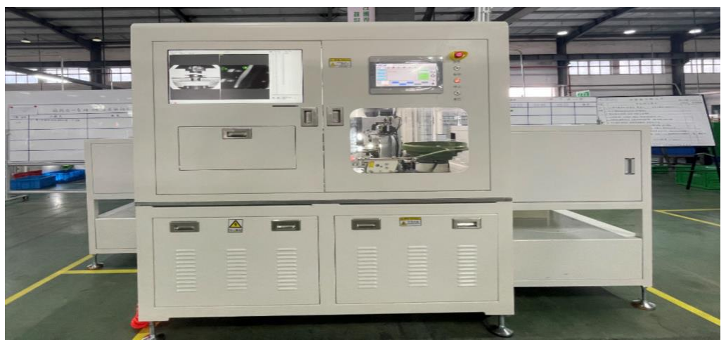
图16: HBQ-G205 光伏连接器自动组装机
