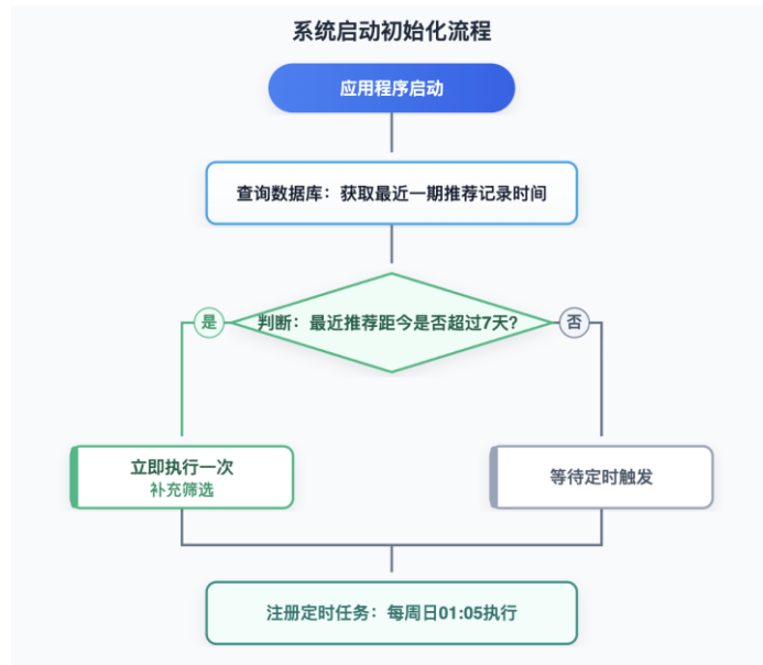
图15: 系统启动初始化流程
