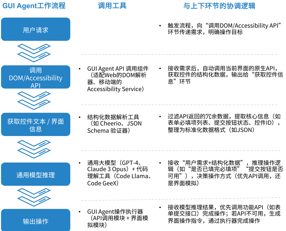
图：代码生成路径工作流程
