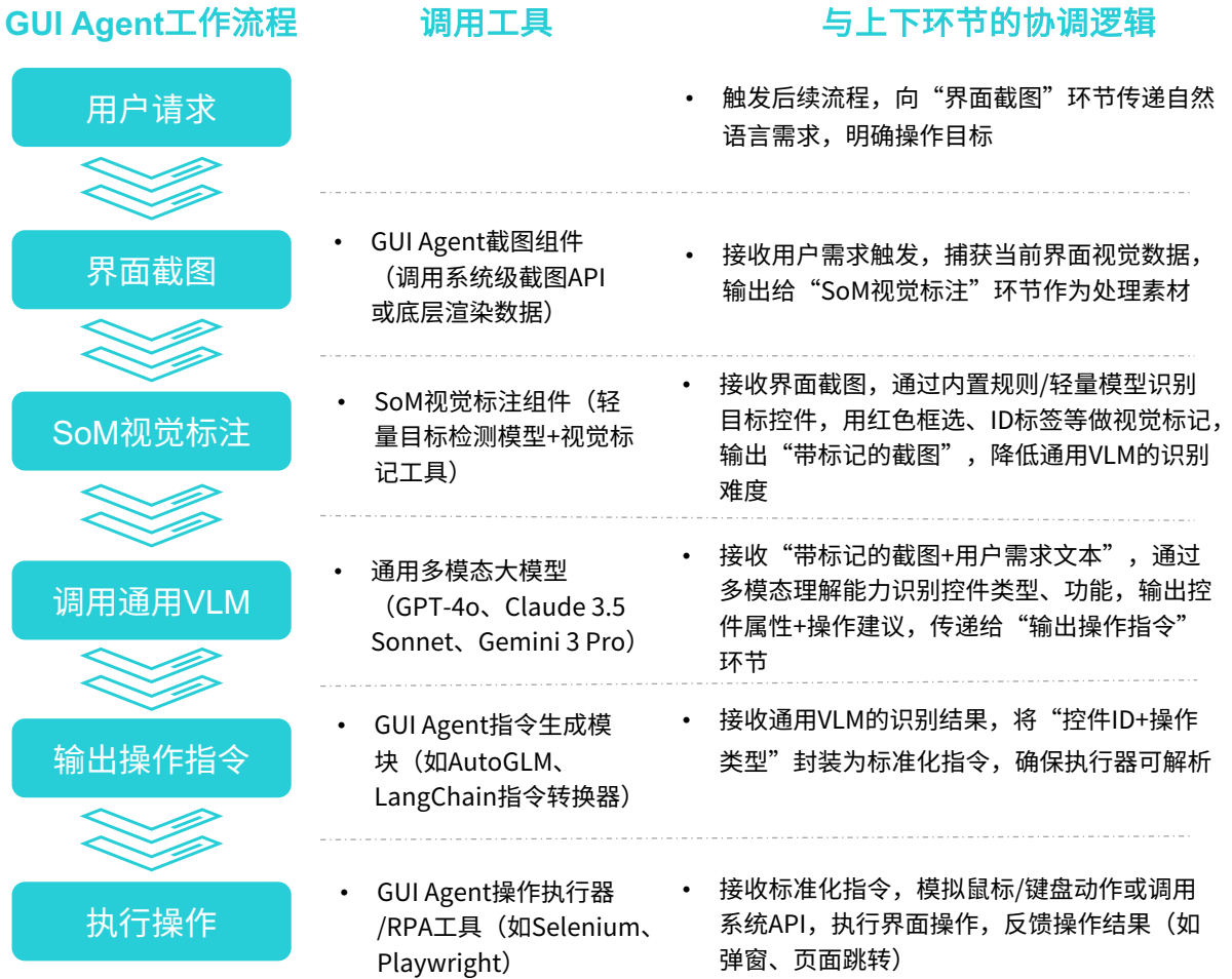
图：通用VLM+视觉提示流GUI Agent工作流程
