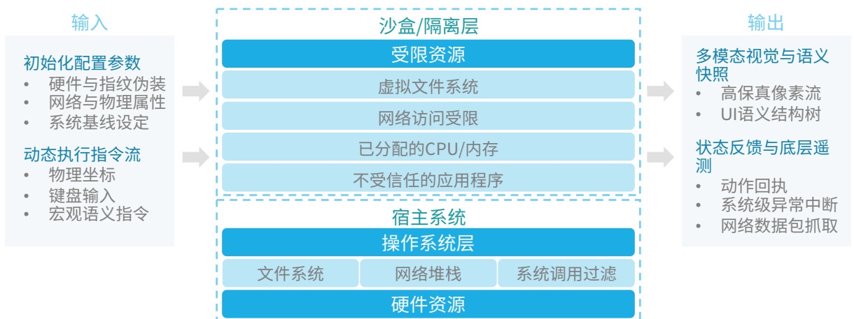
图：沙盒的内部机制以及输入和输出
