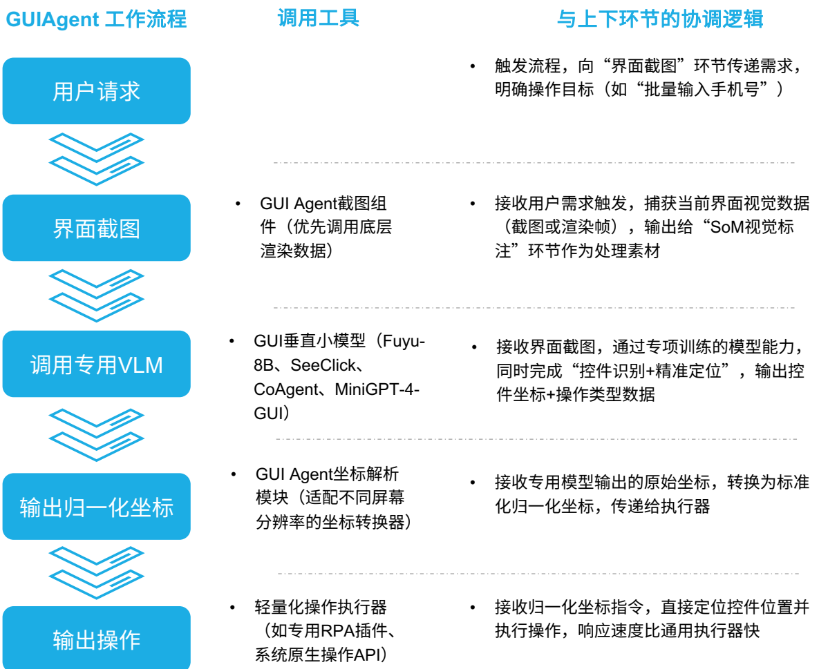
图：垂直端到端模型GUI Agent工作流程
