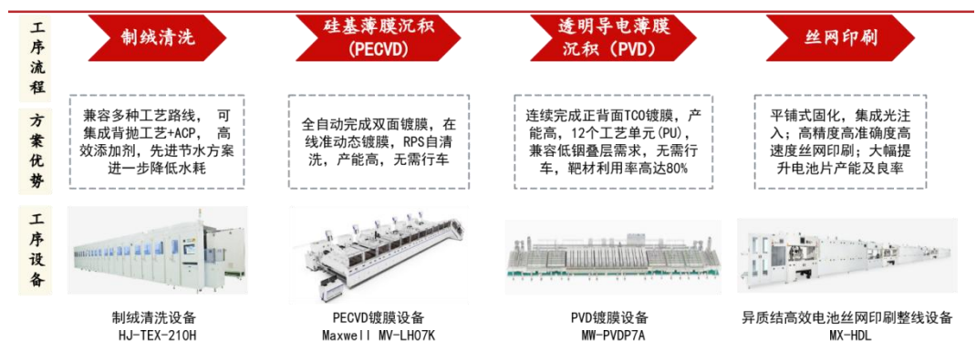
图表 13：GW级双面微晶异质结高效电池制造整体解决方案
