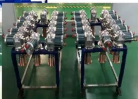
国产大冷量GM制冷机批量化生产应用
