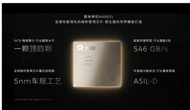
图3：蔚来自研5nm高阶智驾芯片神玑NX9031核心参数
