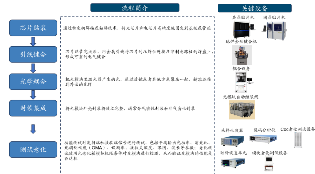
图表7：光模块生产工序有源耦合是核心难点，贴片、测试是高壁垒环节
