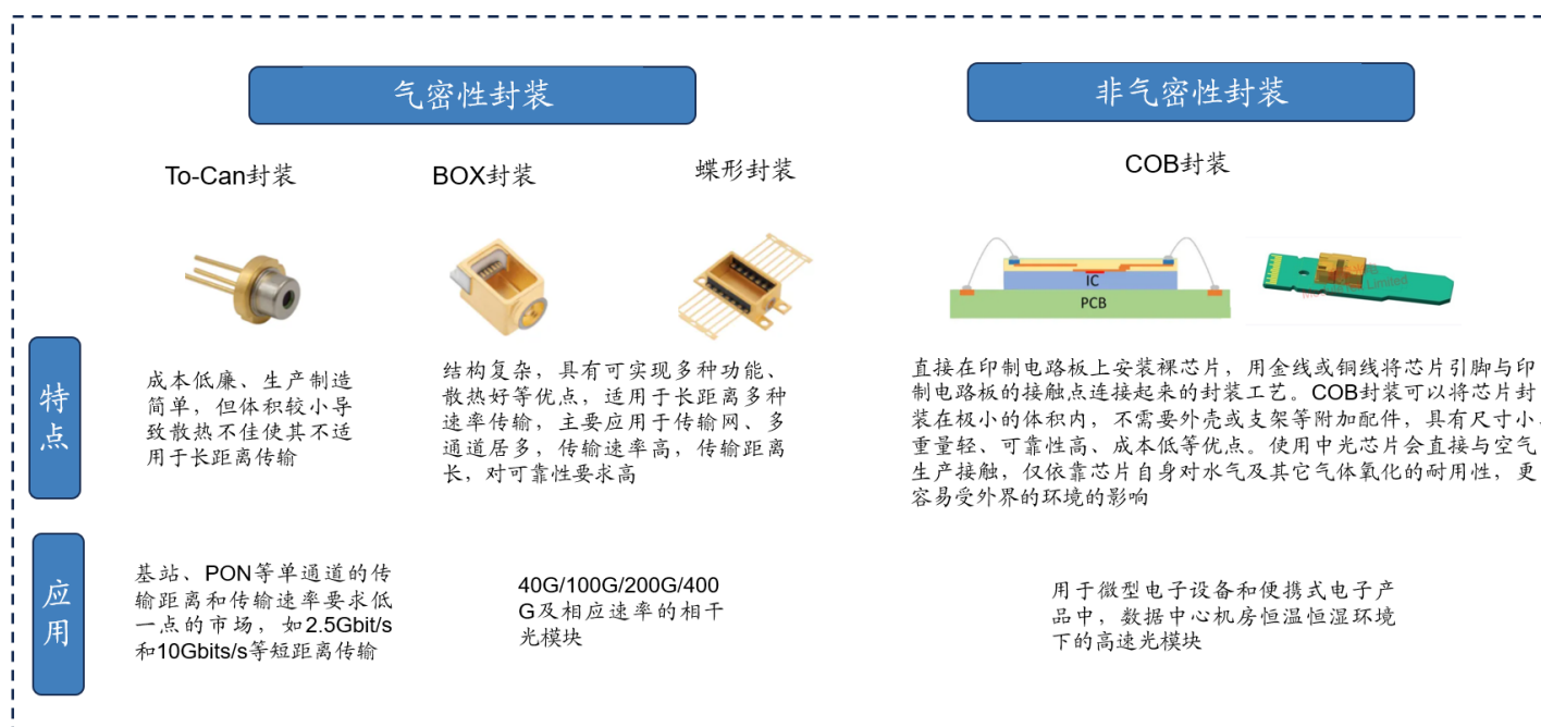
图表15：非气密性封装是高速光模块于数据中心机房应用的主流选择
