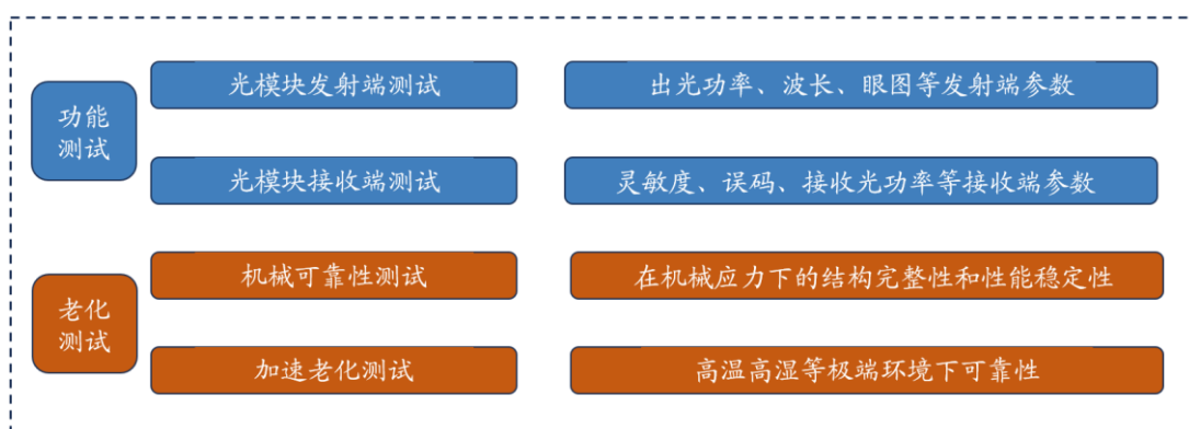
图表16：光模块需要测试其功能与老化可靠性
