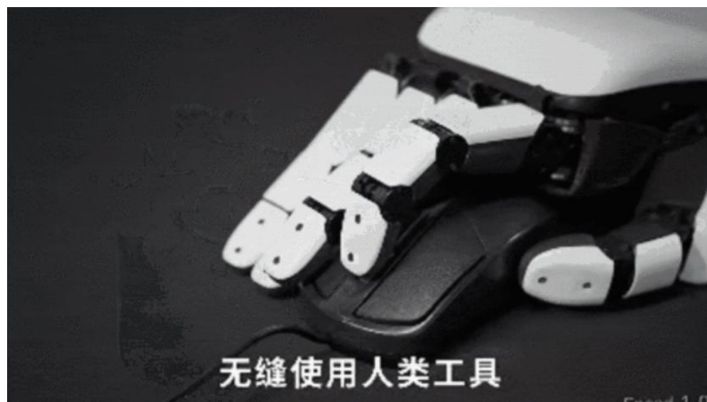
图6: Apex Hand 灵巧手具备 21 自由度
