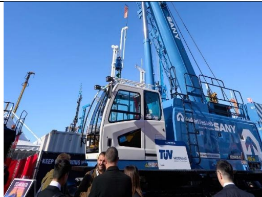
图 43: 全球第一台全电池驱动的伸缩臂履带式起重机 SCE800TB-EV
