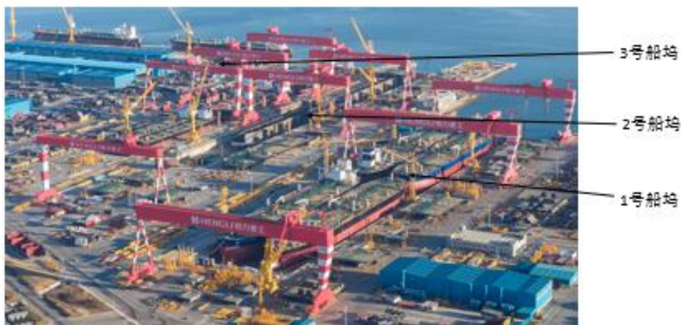
图 32：恒力重工在船坞配备大型龙门吊配合批量化造船
