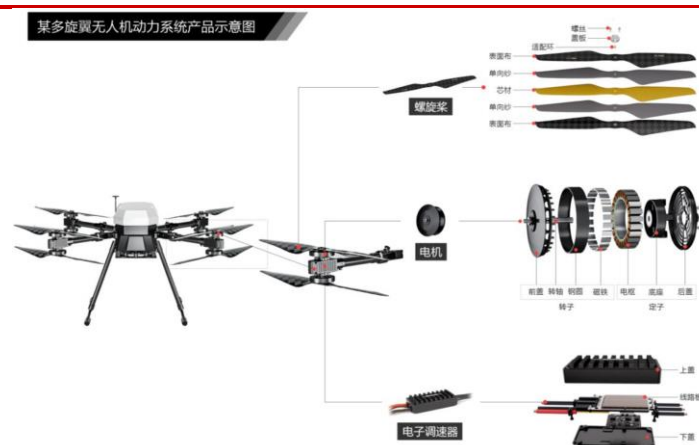
图 9 无人机电动动力系统产品的安装位置及组成情况示意图
