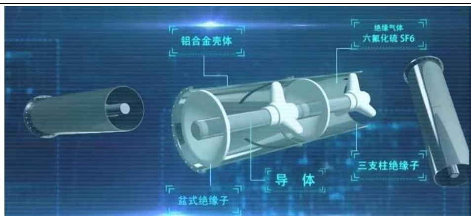
图 3: 应用气体绝缘输电技术的GIL单元示意图, 其内部充满SF6气体
