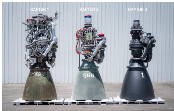
图表 9：猛禽三代型号大量使用 3D 打印隐藏了许多在一代型号中外露的管道和零件，重量由 2.03 吨下降至 1.53 吨
