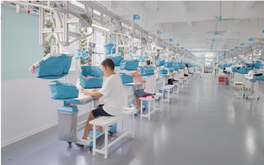
图 SHEIN使用服装自动吊挂系统设备的供应商工厂
