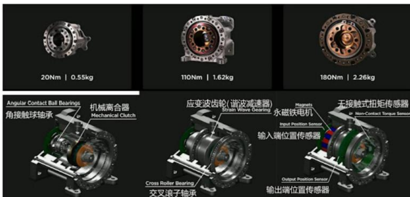
图表30: Optimus 旋转关节示意图
