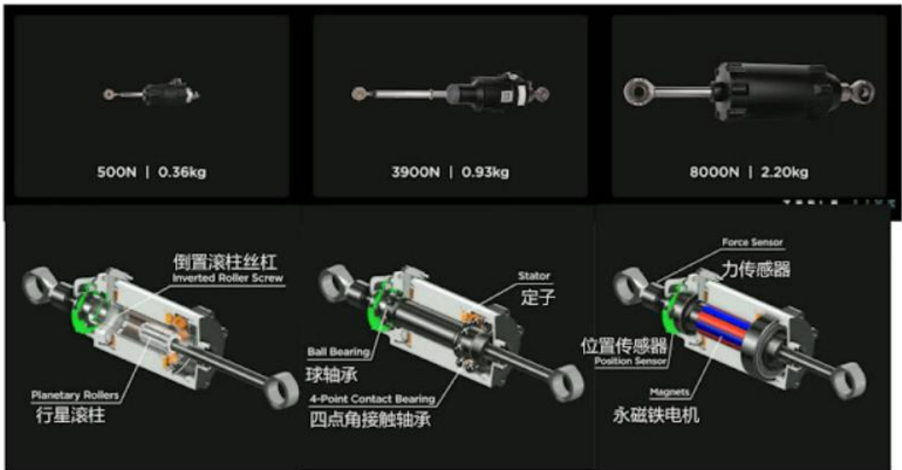
图表31: Optimus 直线关节示意图
