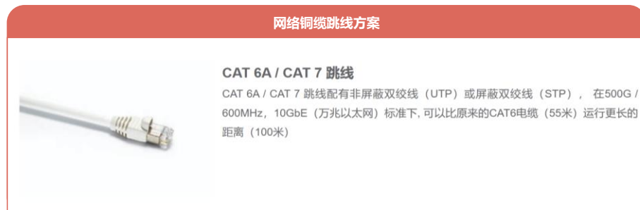
图 38: 公司网络铜缆跳线方案
