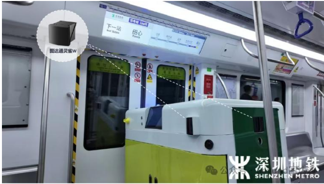
图表29: 搭载图达通广角激光雷达灵雀W的地铁物流机器人
