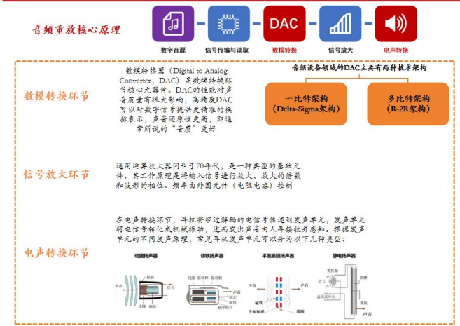
图表 21：音频重放核心原理及技术环节图示
