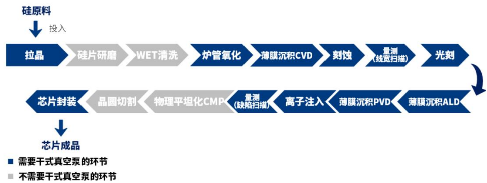
图17: 集成电路制造工艺流程中已使用到干式真空泵的环节示意图
