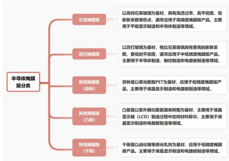
图 8：半导体掩膜版分类——基于基板材料
