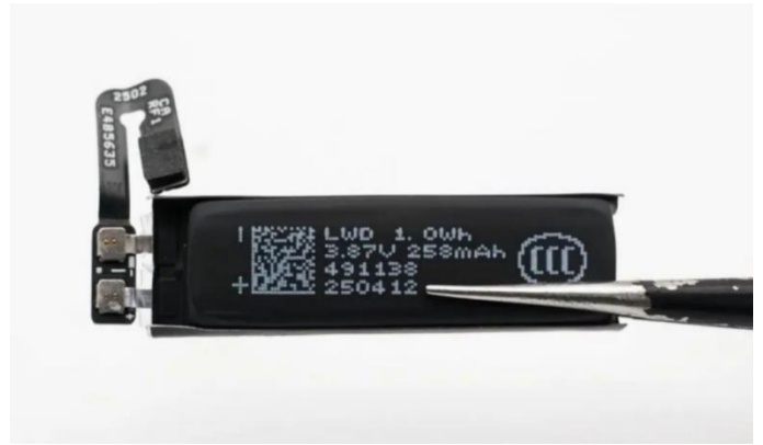
图表 12：内置锂离子聚合物电池示意图（Xiaomi 小米 AI）
