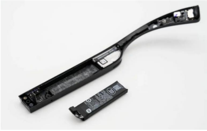
图表 11：内置锂离子聚合物电池示意图（Xiaomi 小米 AI）
