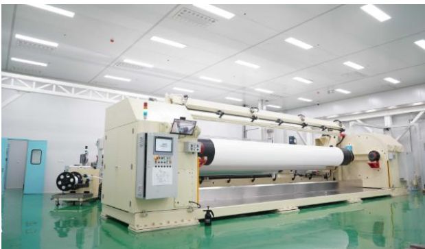
图表 36: 中科华联锂电池隔膜生产演示线打破国外垄断
