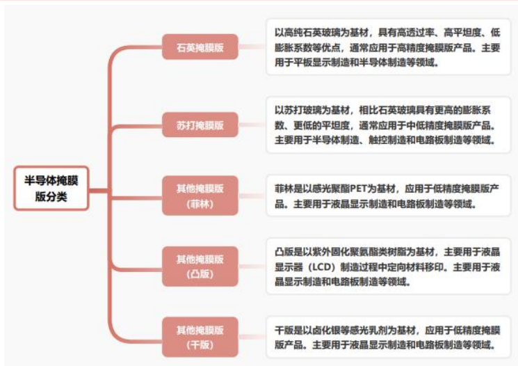
图 8：半导体掩膜版分类——基于基板材料
