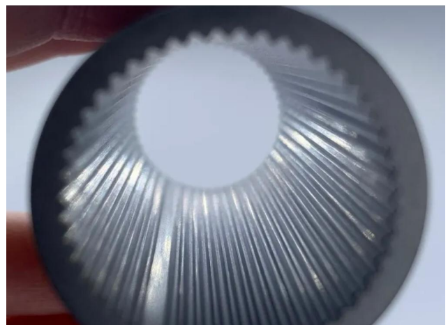
图表 17: 使用旋锻芯棒工件
