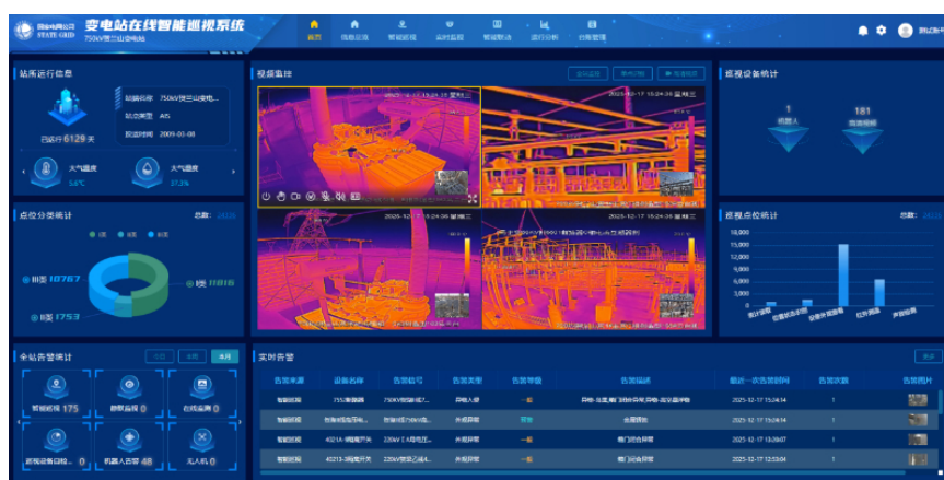
图 3.10: 变电站“空—地—固”协同智能巡检系统界面 [10]
