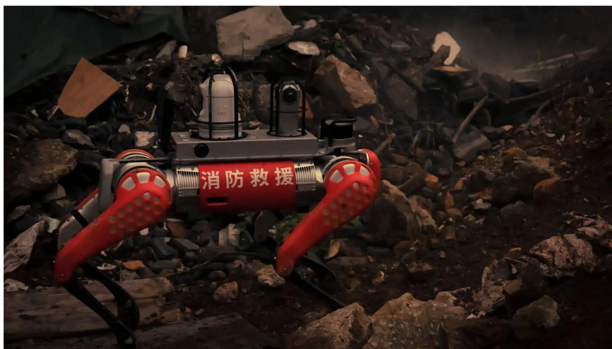
图 3.12: 灾害现场机器人三维勘测与多传感侦察作业示意 [2]
