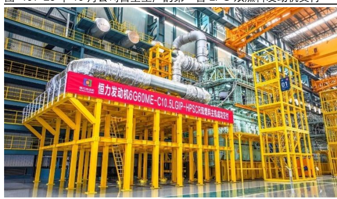
图 40：25 年 10 月公司自主生产的第一台 LPG 双燃料发动机交付
