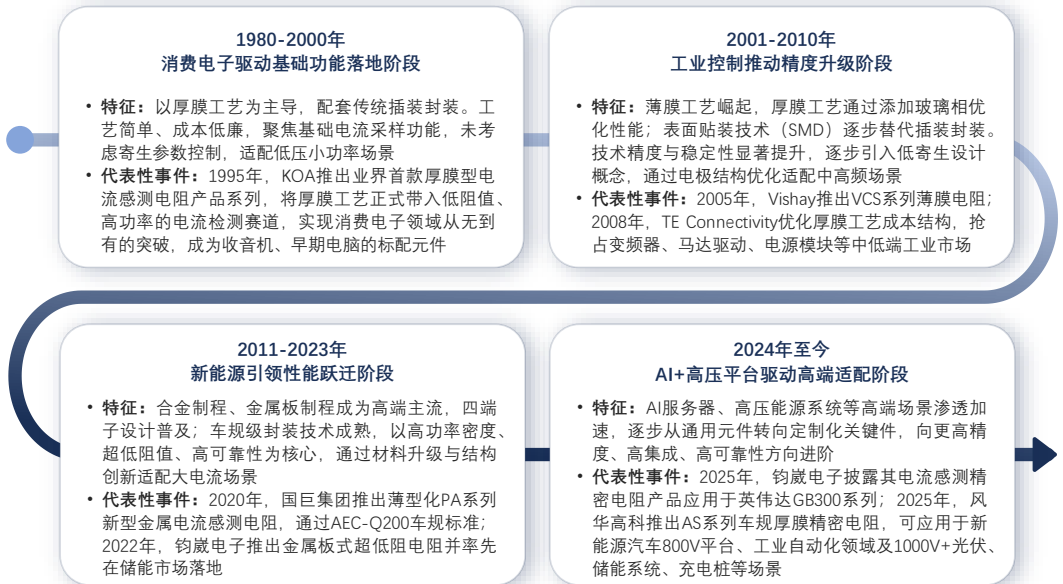
图表4：电流感测精密电阻的发展路径
