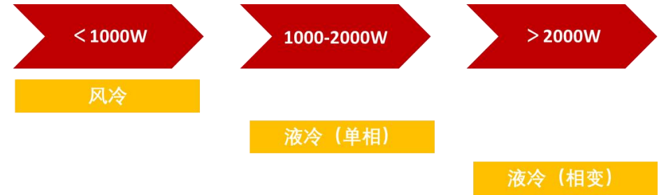
芯片侧不同功耗密度下适宜的散热方式
