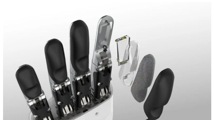
图 10：戴盟视触觉传感器厚度仅为几毫米
