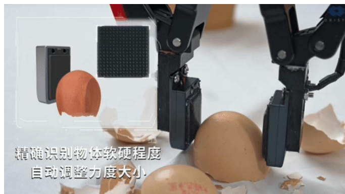
图 2：视触觉传感器精准识别物体软硬程度
