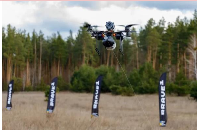
图10: 光纤无人机可以免疫电子战和干扰
