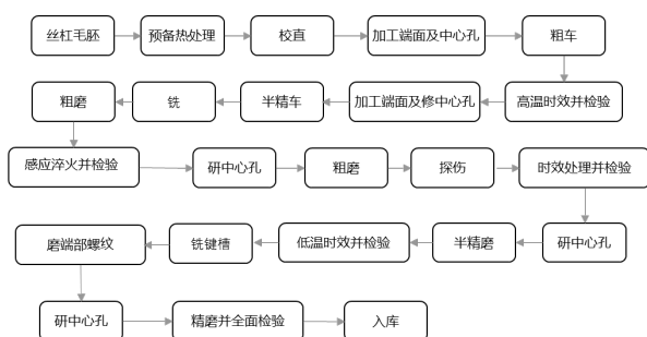
图表40：丝杠工艺流程
