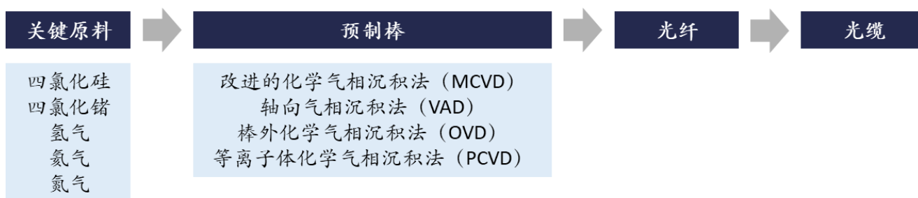
图表19: 光纤生产制造流程
