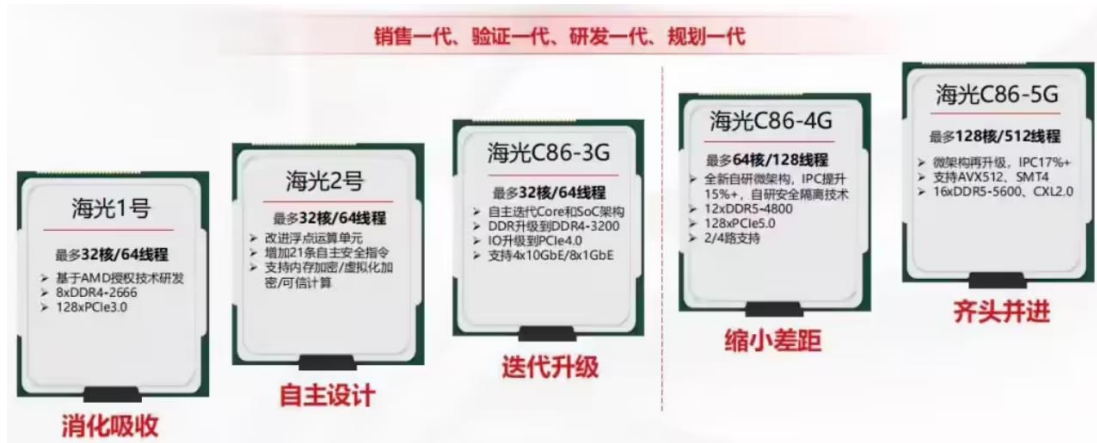
图表33: 海光 CPU 架构持续迭代升级, 最新第五代处理器将通过 SMT-4 技术实现单核 4 线程并发
