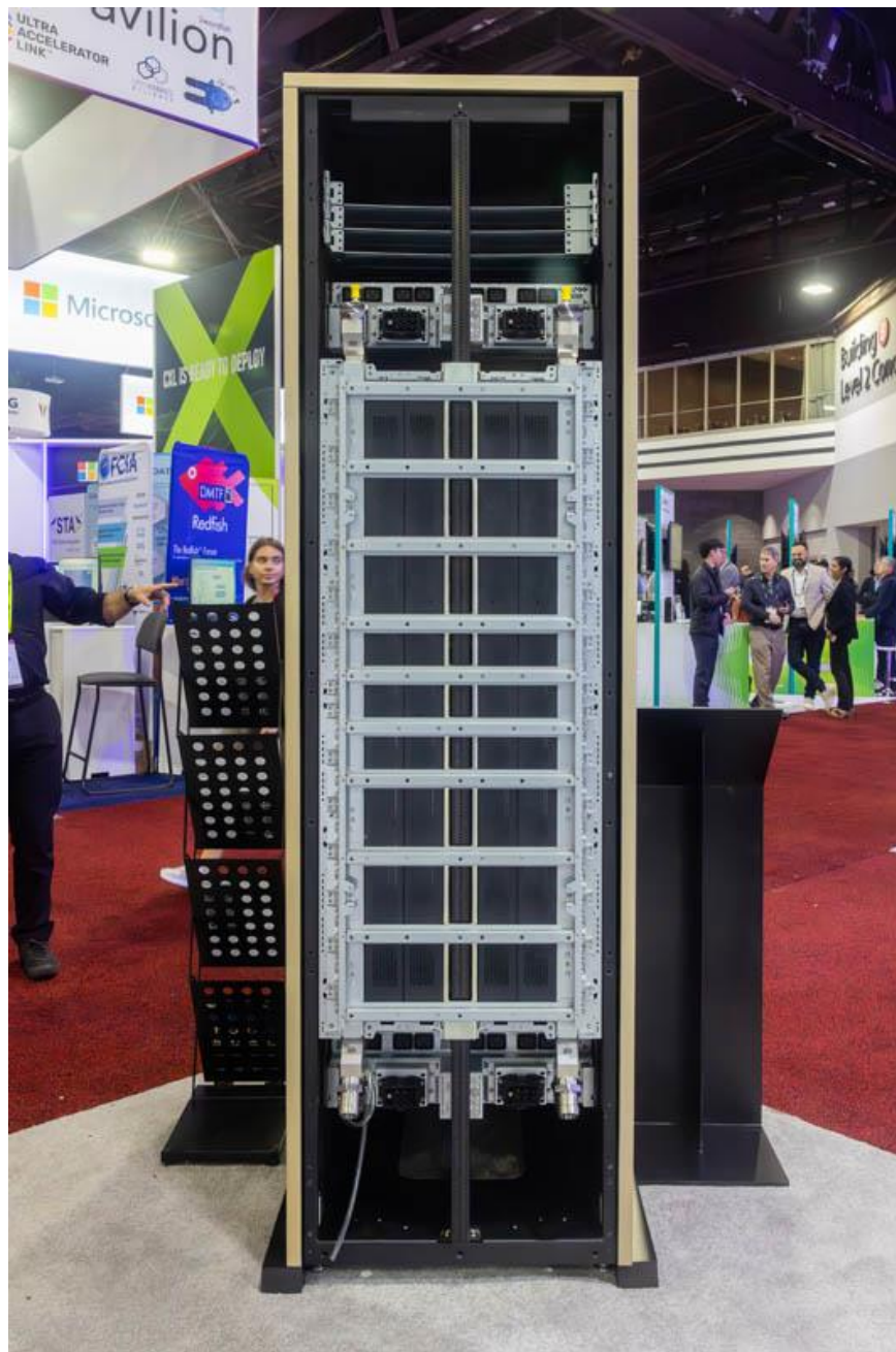
图表9：NVIDIA Rubin NVL576 机架取消了连接 NV Link 交换机和计算刀片的线缆卡带
