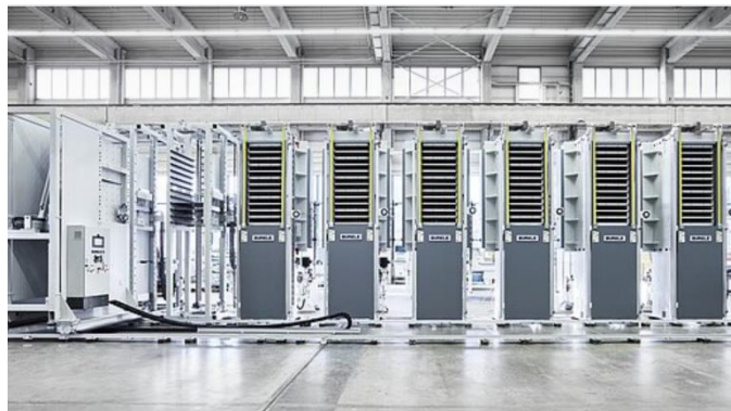
图表22：MULTILAM PCB press:Bürkle 公司大型系列设备
