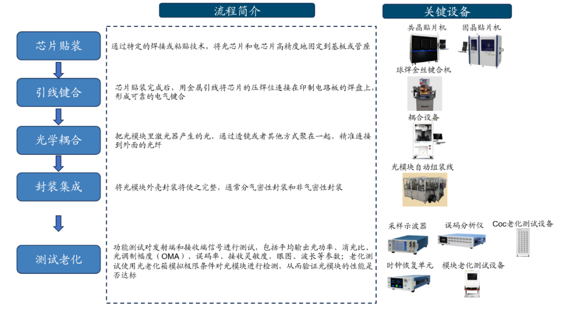
图表12：光模块生产工序有源耦合是核心难点，贴片、测试是高壁垒环节
